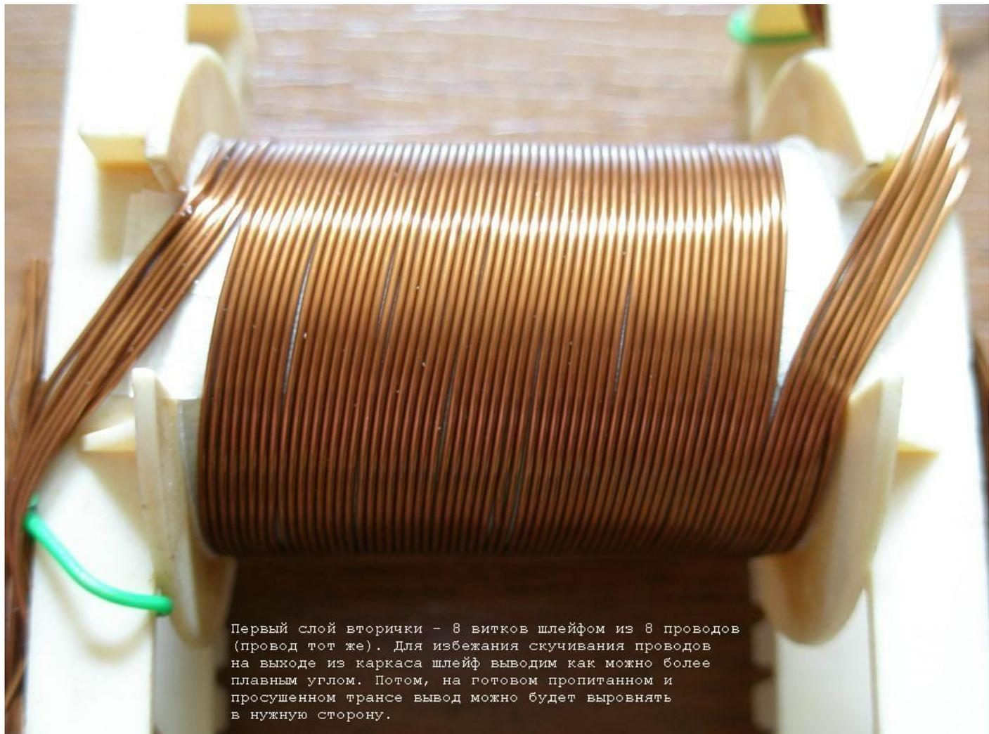
Первый слой вторички - 8 витков шлейфом из 8 проводов (провод тот же). Для избежания скучивания проводов на выходе из каркаса шлейф выводим как можно более плавным углом. Потом, на готовом пропитанном и просушенном транссе вывод можно будет выровнять в нужную сторону.
